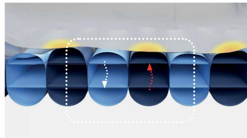
Grâce à son système d'alternance à deux cellules, Air2Care réduit la pression et permet de minimiser les pics de pression exercés sur le corps du patient.
